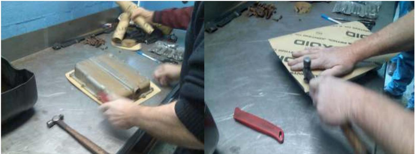
**FABRICATING A TRANSMISSION PAN GASKET.**
